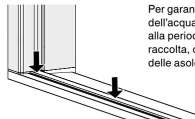
Per garantire un efficiente deflusso dell'acqua, occorre provvedere alla periodica pulizia della vasca di raccolta, onde evitare l'ostruzione delle asole di deflusso.
