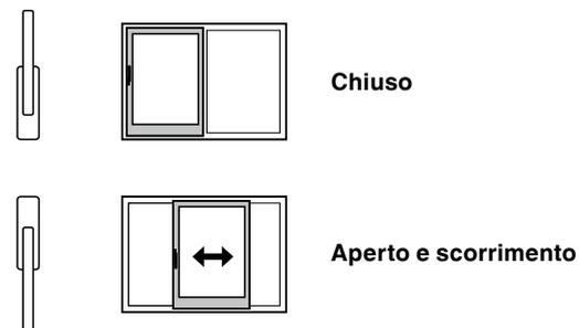
Applicare in modo ben visibile l'etichetta con le indicazioni d'uso sul battente del serramento scorrevole montato.
